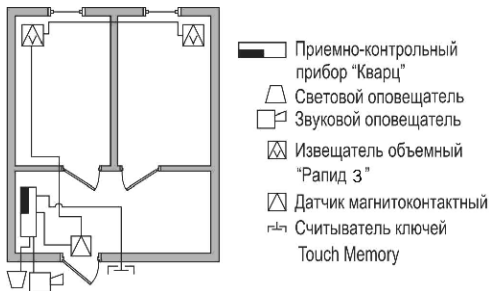
Рис. 1 Схема расположения приборов системы охранной сигнализации «Защити себя сам» в одноэтажном здании
